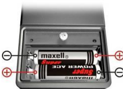
Рисунок 3 – схема установки батарей в корпус изделия.
